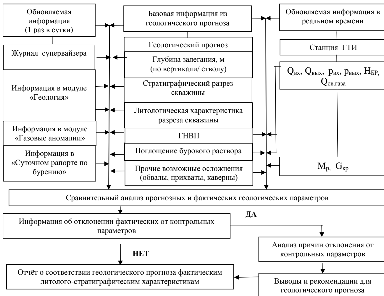
Рис. 2.3. Поступление информации для оценки соответствия геологического прогноза фактическим литолого-стратиграфическим характеристикам: Q_{вх} – расход БР на входе в скважину, Q_{вых} – расход БР на выходе из скважины, H_{БР} – уровень БР в емкостях, \rho_{вх} – плотность БР на входе в скважину, \rho_{вых} – плотность БР на выходе из скважины, Q_{св.газа} – объемное содержание свободного газа в БР на выходе из скважины, M_p – крутящий момент на роторе, G_{кр} – вес на крюке
